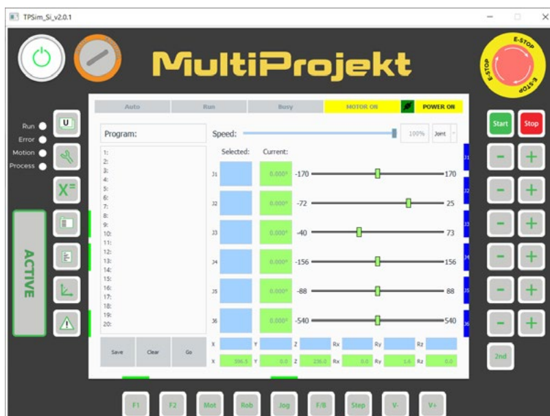
Rys. 16. Tryb Manual w gotowości do poruszania robotem
